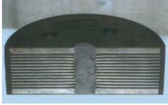
Şekil 12 - Kurşun Çekirdekli Kauçuk İzolatör
